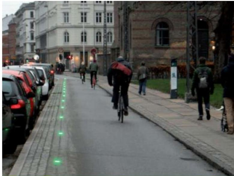
Abbildung 42: Angezeigte Grüne Welle mittels LED-Lauflicht
