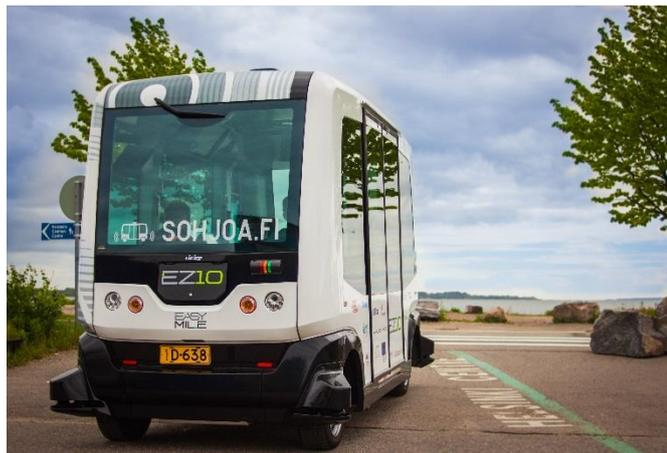
Abbildung 61: Autonomes Shuttle EasyMile EZ10 im Forschungsprojekt Sohjoa Baltic
