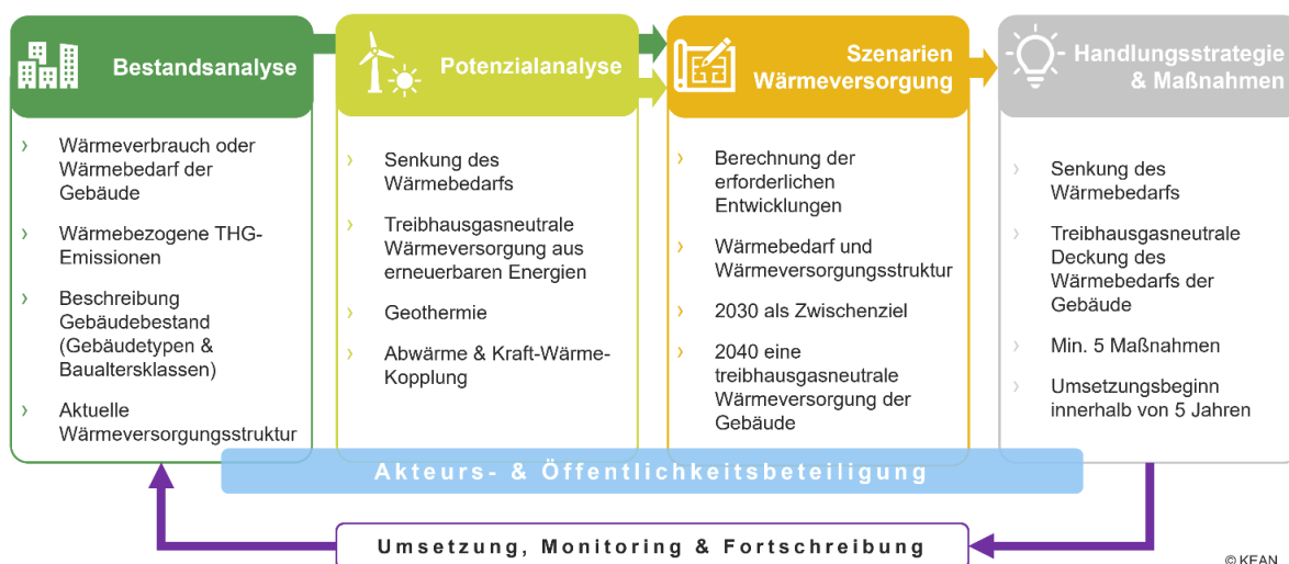
Abbildung 2-1: Ablauf der kommunalen Wärmeplanung (Quelle: KEAN)
